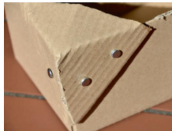
**Verbindungen mit Kabelbindern und Rundkopfklammern.**
