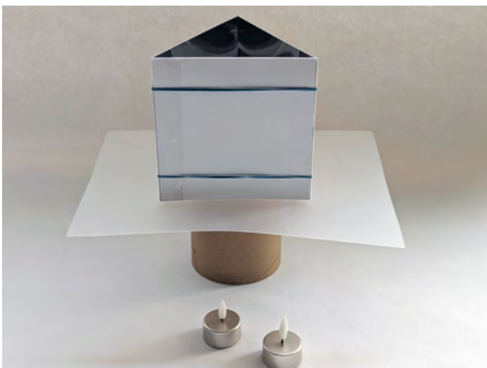
Die leuchtenden LED-Lichter in die Röhre stellen, die matte Platte auflegen und das Spiegeldreieck darauf platzieren. Wenige Objekte im Innern anordnen.
